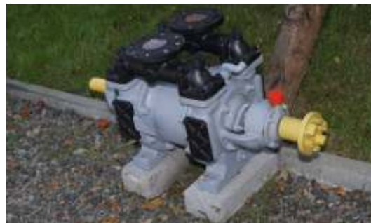
131: Suflantă de aer - utilizată pentru barbotarea aerului în bazinul de dizolvare sulfat de aluminiu
