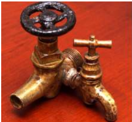
039: Robinet trecere - se folosea în căminul de apometru și era montat după contorul de apă pentru golirea rețelei în caz de avarie
