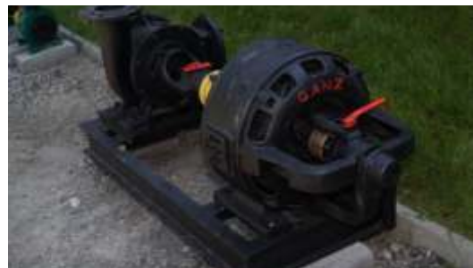
132: Pompă centrifugă GANZ cu motor deschis - probabil de fabricație interbelică. Utilizată pentru spălarea anuală a puțurilor în perioada în care se folosea și apă freatică.
