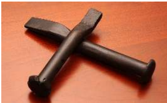
044: Stemuitoare de plumb și de frînghie - scule folosite pentru îmbinarea țevelor de fonta cu mufă
