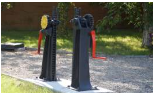
128: Dispozitiv de ridicare stavilă - utilizat la admisia apei brute în deznisipatorul acoperit cu pământ, pus în funcțiune la 01/12/1948 și scos din funcțiune în anul 2007
