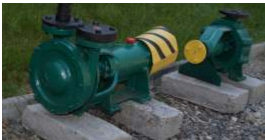
127: Pompă centrifugă - pentru transportul soluției de sulfat de aluminiu
