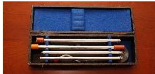
048: Hidrofon - folosit la detectarea spărturilor pe rețeaua de apă din pereți, pământ etc.
