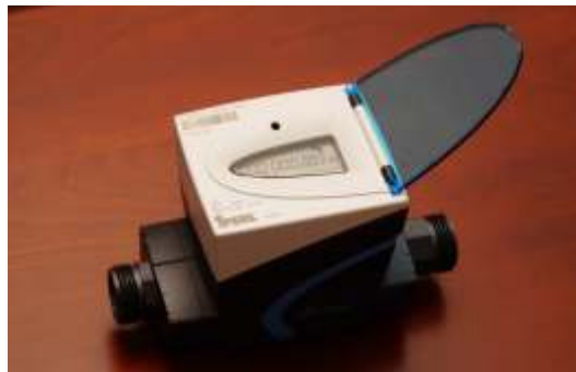
041: Apometru iPEARL - contor cu măsurare în câmp electromagnetic și citire de la distanță, clasă de precizie ridicată - R800
